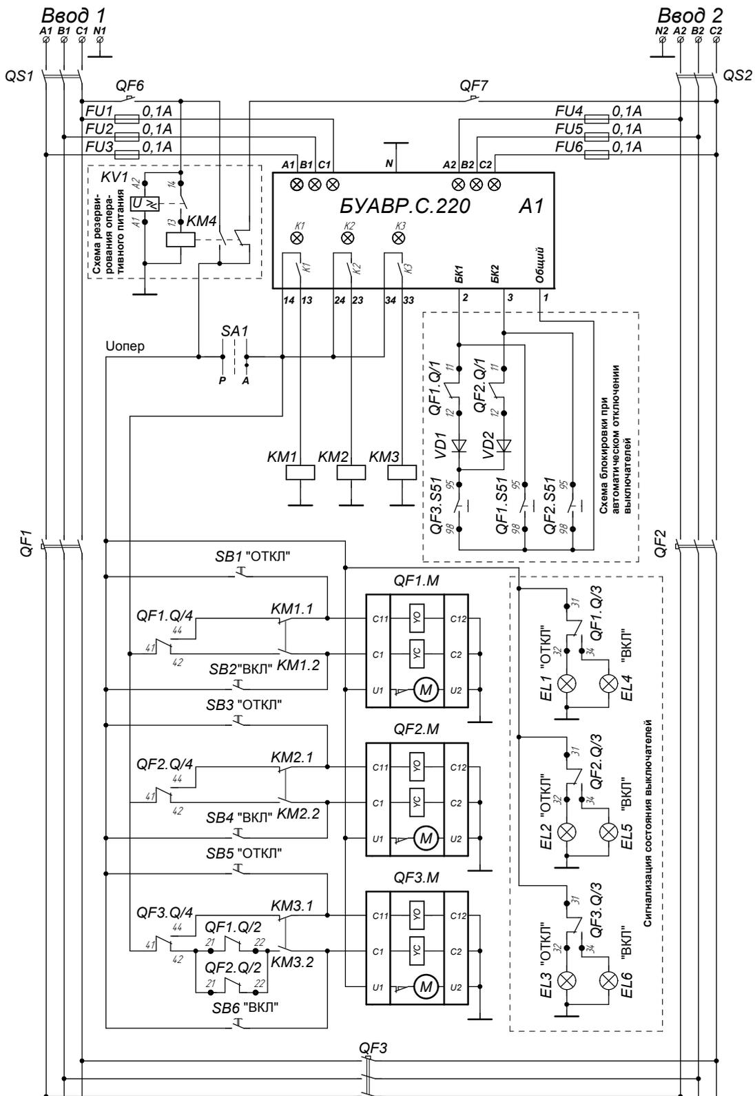
**QF1-QF3** - Автоматические выключатели серии Тмах, типоразмер Т7 с электродвигателем для взвода включающих пружин, с электромагнитами включения, отключения и вспомогательными контактами
