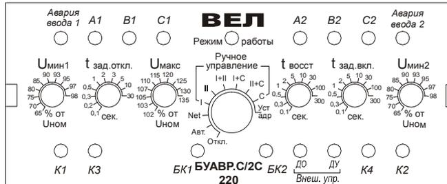
Рис. 2 Расположение органов управления и индикации БУАВР.С
